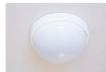
安心のリズムセンサー ご入居者の生活リズムをチェック。入室して12時間動きがなければスタッフに知らせます。
